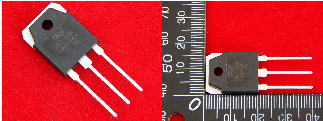
Диод силовой D92-02. В корпусе ТО-3Р.
