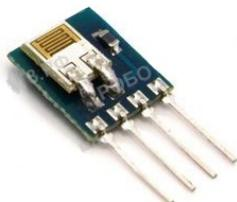
Датчик DHT11 без корпуса
