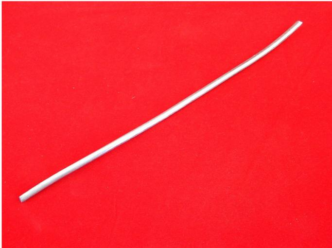
Припой ПОС 40 используется для лужения и пайки электроаппаратуры, деталей из оцинкованного железа с герметичными швами.
