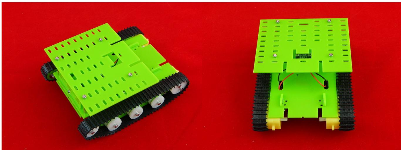
Шасси с гусеницами специально разработанное для студентов и любителей роботов. Данная платформа является несущей частью оборудования и предназначена для установки на нее собственных комплектов электроники.
