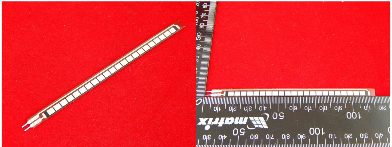
Датчик изгиба (тензорезистор), длина 4,5 дюйма (11.4 см). При изгибе пропорционально растет сопротивление. Изготовлен по патентованной технологии Spectra Symbol, подобные сенсоры используются в перчатках Nintendo Power Glove.
