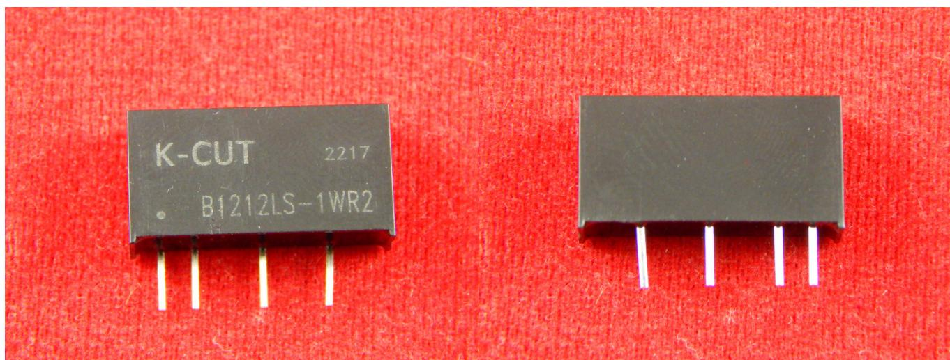
B1212LS-1WR2 - миниатюрные DC-DC преобразователи из 12В в 12В, с гальванической развязкой 1500В DC/1мин и выходной мощностью 1Вт.
