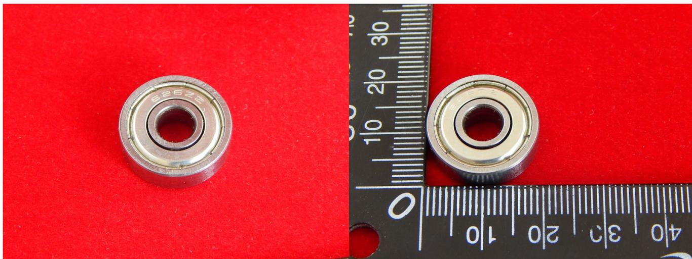
626ZZ подшипник для миниатюрных моделей. Его внутренний диаметр 6 мм, а внешний 19 мм.
