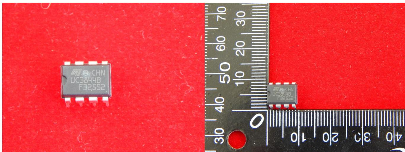
Широтно-импульсный модулятор UC3844B может использоваться в импульсных блоках питания, в зарядных устройствах для телефонов плееров т.п., в системах питания бытовой техники (компьютеры, телевизоры, мониторы).
