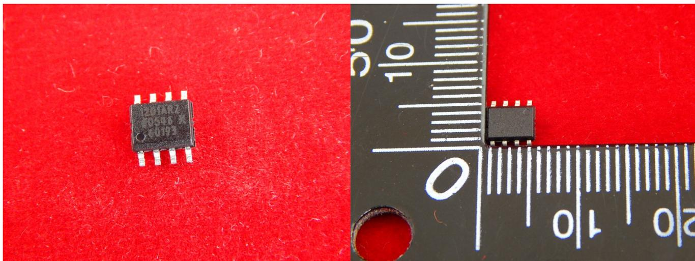
ADUM1201ARZ является двухканальным цифровым изолятором на базе технологии iCoupler®. Объединяя высокоскоростную КМОП и технологии монолитного трансформатора, эти компоненты обеспечивают отличные характеристики производительности, превосходя альтернативные компоненты вроде оптопар.
