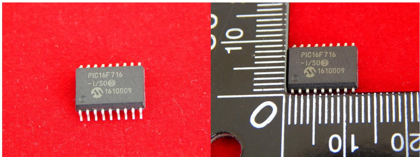
PIC16F716-I/SO, Микроконтроллер 8 бит, Flash, AEC-Q100, PIC16F, 20 МГц, 3.5 КБ, 128 Байт, 18 вывод(-ов), SOIC
