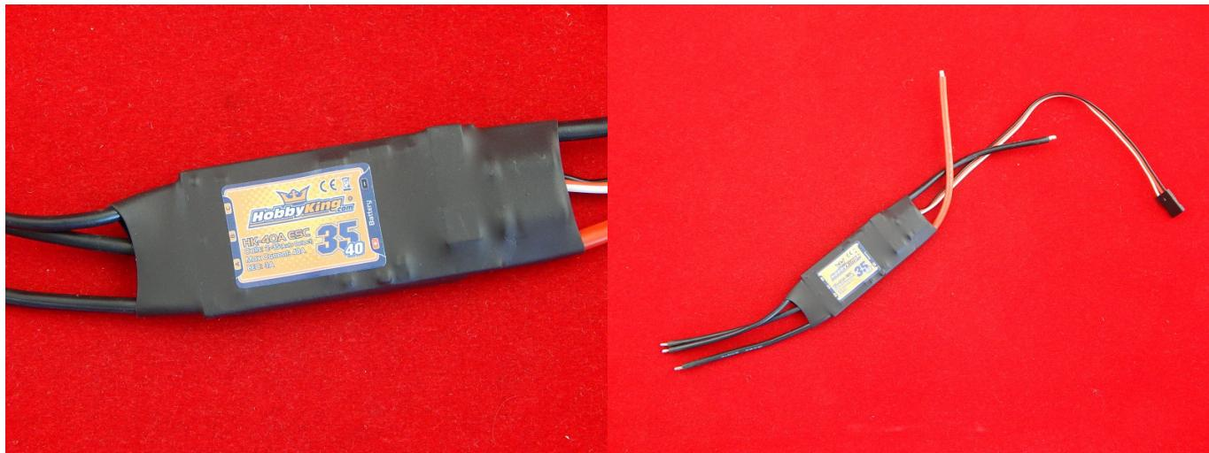
Электронный регулятор хода для бесколлекторных двигателей. Позволяет регулировать обороты двигателя с потреблением тока до 40А. Работает от Li-xx и Ni-xx аккумуляторов.
