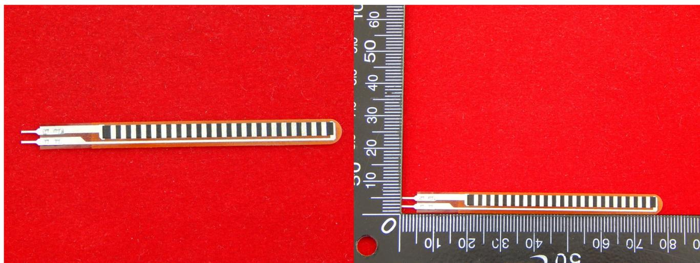
Датчик изгиба (тензорезистор), длина 2,2 дюйма (5.6 см). При изгибе пропорционально растет сопротивление. Изготовлен по патентованной технологии Spectra Symbol, подобные сенсоры используются в перчатках Nintendo Power Glove.
