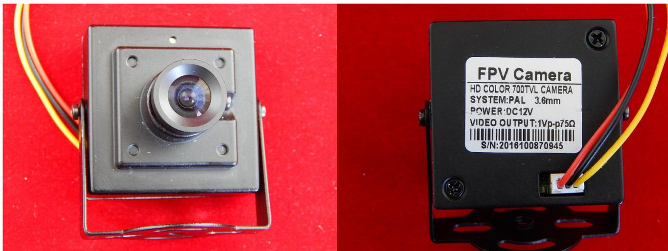
Камера для использования в FPV системах.
