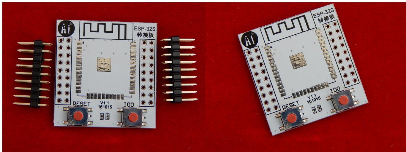
Монтажная плата подходит для Wi-Fi модуля ESP-32S
