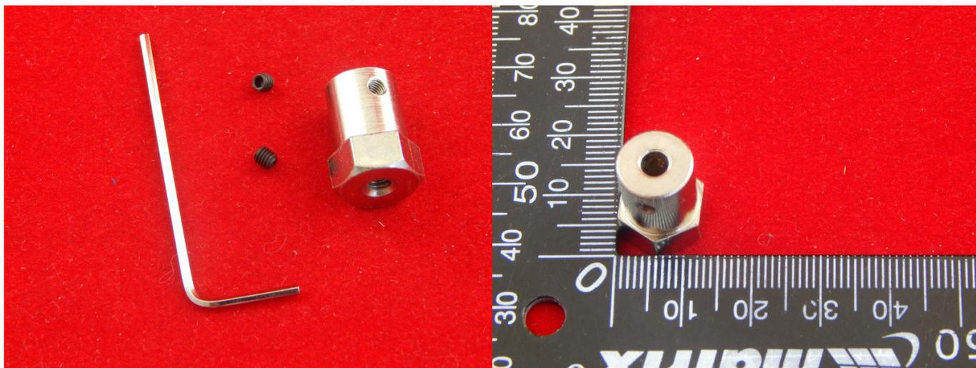
Насадка позволяет закрепить колесо на валу любого мотор-редуктора. Диаметр вала ( оси ) двигателя должен быть 4 мм.
