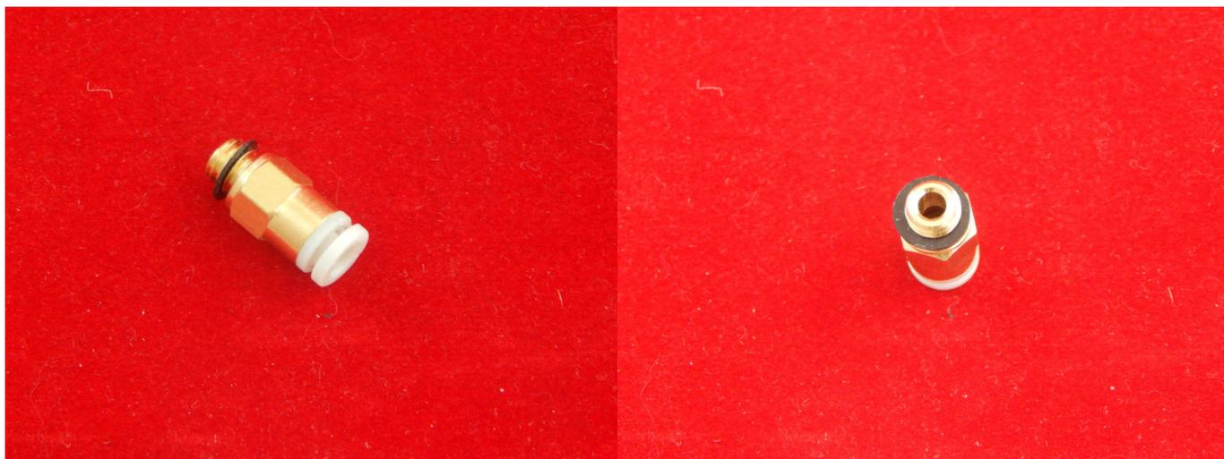
Фитинг необходим для фиксации тефлоновой трубки с внешним диаметром 4 мм на экструдере с резьбой М6.
