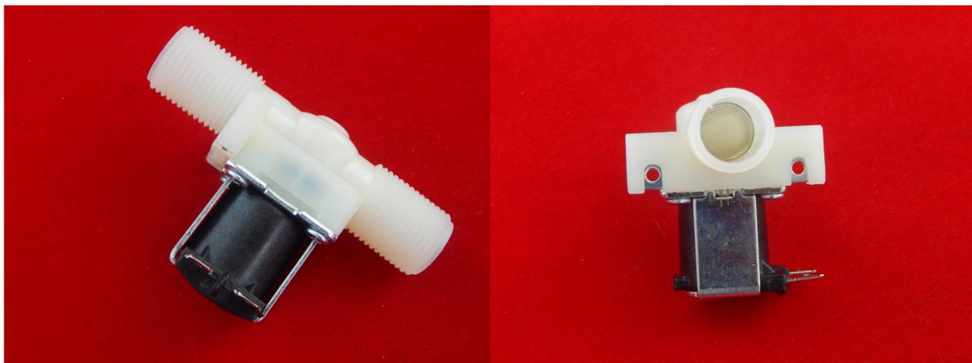
Клапан электромагнитный нормально закрытый — это магнитный клапан, в котором закрытое положение сохраняется, если напряжение на индукционную катушку не подаётся. При подаче напряжения на индукционную катушку клапан электромагнитный нормально закрытый открывается
