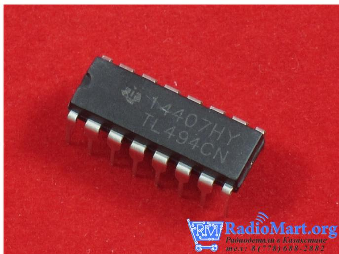
Микросхема TL494 представляет из себя ШИМ-контролер импульсного источника питания, работающий на фиксированной частоте, и включает в себя все необходимые для этого блоки. Встроенный генератор пилообразного напряжения требует для установке частоты только двух внешних компонентов R и C.
