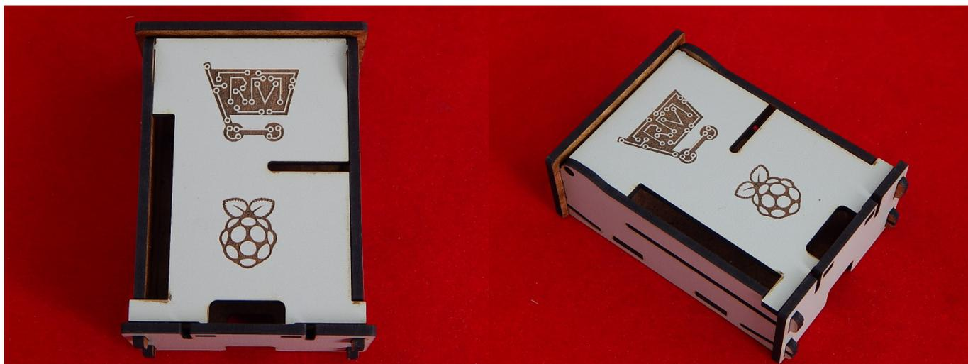
Корпус спроектирован специально для размещения в нём Raspberry Pi 2 Model B.
