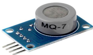
Основным рабочим элементом датчика является нагревательный элемент, за счет которого происходит химическая реакция, в результате которой получается информация о концентрации газа. Поэтому во время работы сенсор будет горячим. Для получения стабильных показаний новый сенсор необходимо один раз прогреть (оставить включённым) в течение 48 часов. После этого стабилизация после включения будет занимать около минуты.
