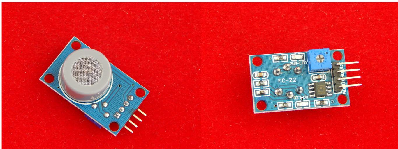
Модуль датчика MQ-7 предназначен для определения концентрации угарного газа в воздухе. Определяет концентрацию газа в пределах от 20 до 2000 ppm. Чувствительность датчика регулируется с помощью потенциометра.
