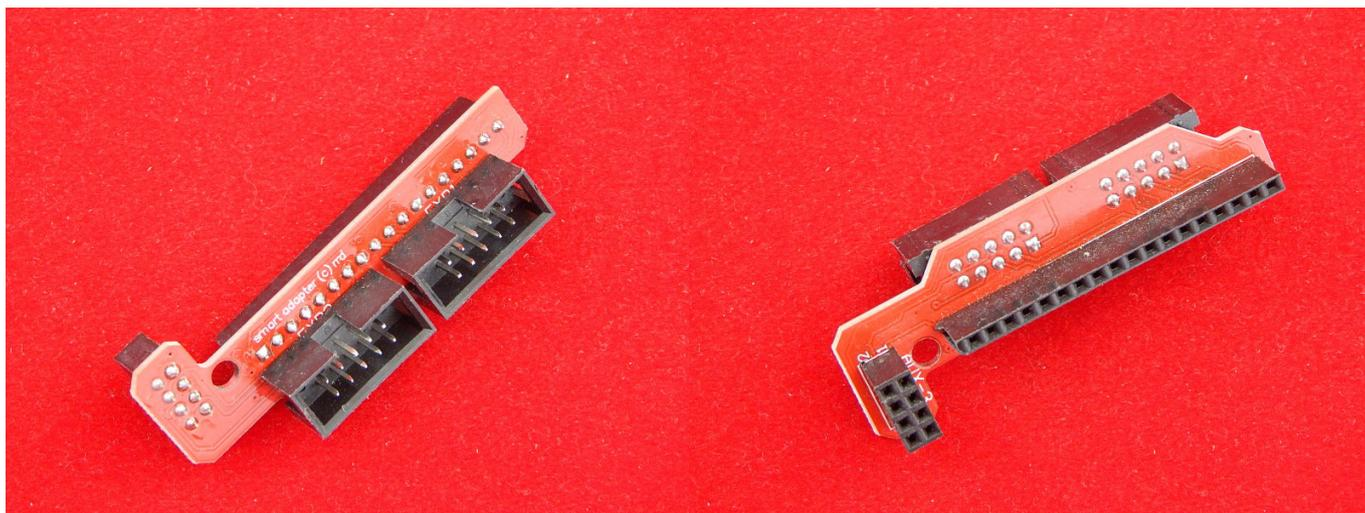
разъем для подключения экрана LCD 2004 12864 к RAMPS 1.4
