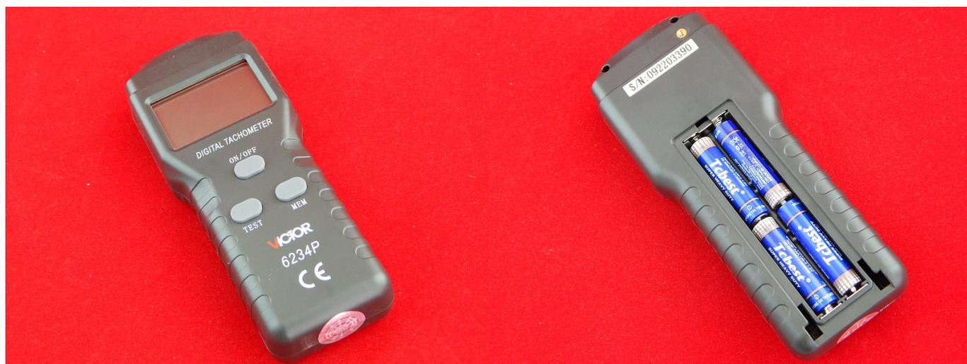
Тахометр – это легкое, компактное устройство которое может контролировать не только вращательные механические движения, но также колебательные или поступательные. Однокристалльный микрокомпьютер, фотоэлектрическая технология измерения, использование антиинтерференционной технологии для повышения точности измерения частоты вращения.
