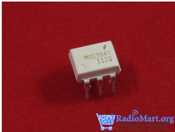
Оптосимисторы принадлежат к классу оптронов и обеспечивают очень хорошую гальваническую развязку (порядка 7500 В) между управляющей цепью и нагрузкой.
