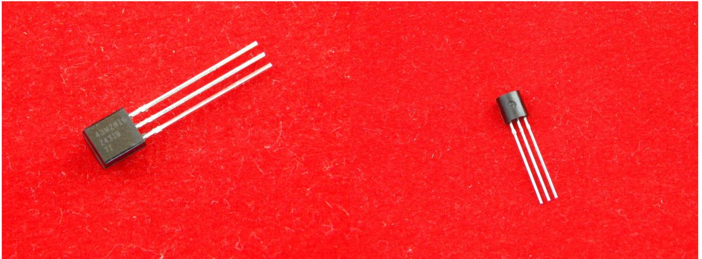
Микросхема TL431 — это регулируемый стабилитрон. Используется в роли источника опорного напряжения в схемах различных блоков питания.
