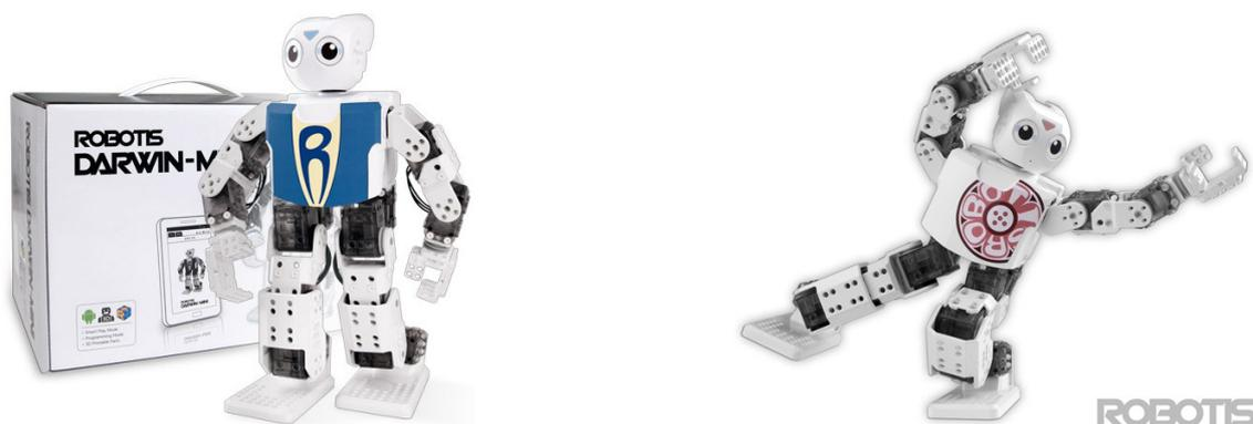
Человекоподобный робот с открытым аппаратным и программным обеспечением, управляемый с планшета или смартфона. В основе робота лежат сервомоторы Dynamixel серии XL, контроллер OpenCM9.04-с и пластиковые детали на основе OLLO.
