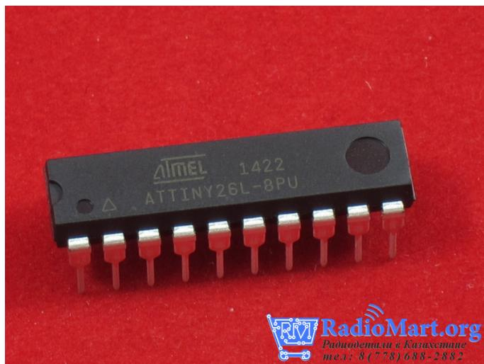
ATtiny26/L является КМОП 8-битным микроконтроллером построенным на расширенной AVR RISC архитектуре. Используя команды исполняемые за один машинный такт, контроллер достигает производительности в 1 MIPS на рабочей частоте 1 МГц, что позволяет разработчику эффективно оптимизировать потребление энергии за счёт выбора оптимальной производительности.
