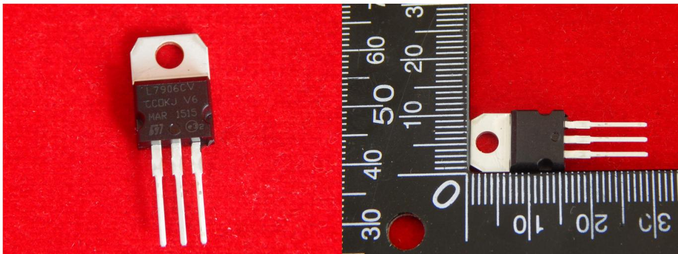
Линейный стабилизатор напряжения L7906CV Negative, корпус TO-220
