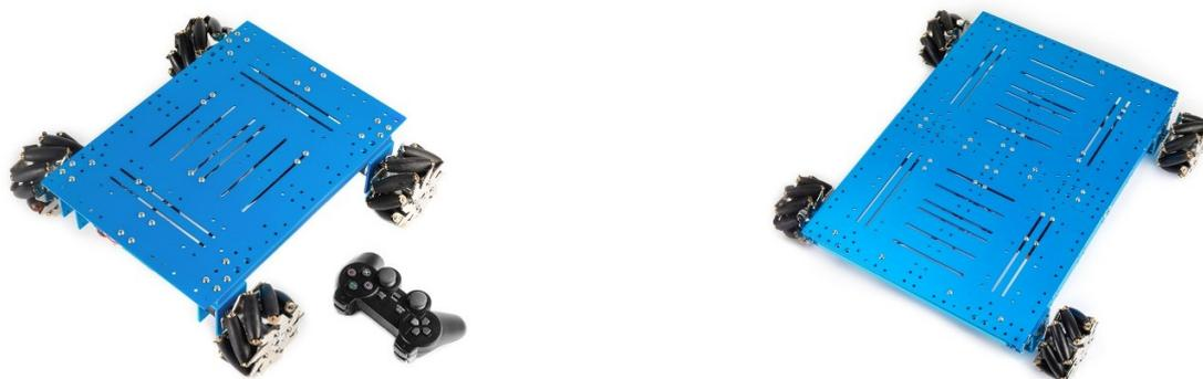
**Mecanum Wheel Robot Kit** - это тип мобильного шасси-робота, основанного на оборудовании с открытым исходным кодом от Makeblock. Шасси этого комплекта состоит из колеса **mecanum**, драйвера двигателя энкодера, механической структуры и других электронных модулей (например, основного контроллера).
