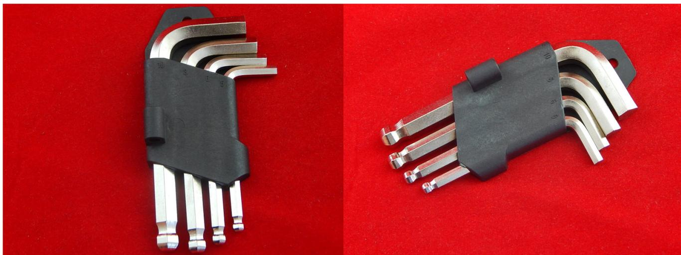
Шестигранные ключи предназначены для монтажа крепёжных элементов, имеющих шестигранный шлиц. Набор незаменим при обслуживании автомобилей, велосипедов, техники, при сборке мебели и другого оборудования. За счёт удлинённой конструкции позволяют добраться до труднодоступных крепежей. Шарообразный наконечник позволяет работать с крепежом под углом до 30° к его оси.
