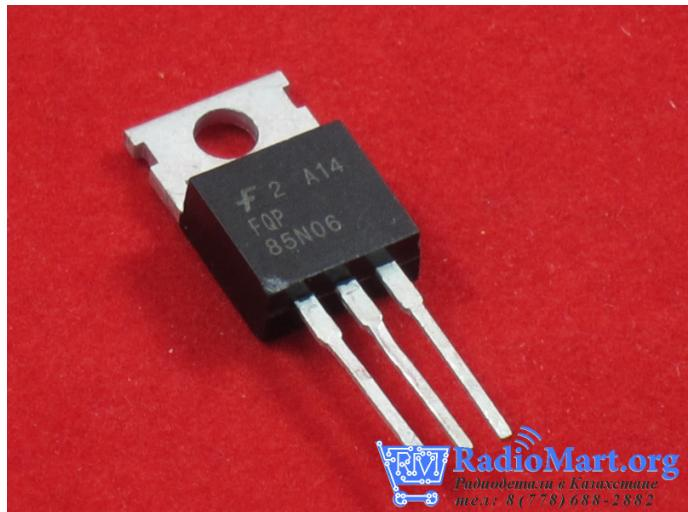
Транзисторы на основе МОП-структур называют полевыми транзисторами с изолированным затвором, или МОП-транзисторами (англ. metal-oxide-semiconductor field effect transistor, MOSFET).
