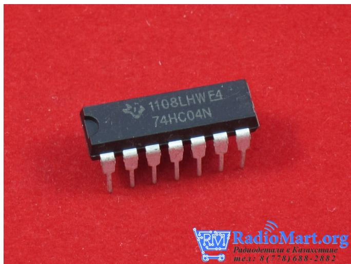
Микросхема 74HC04N содержит шесть стандартных инверторов структуры ТТЛШ.
