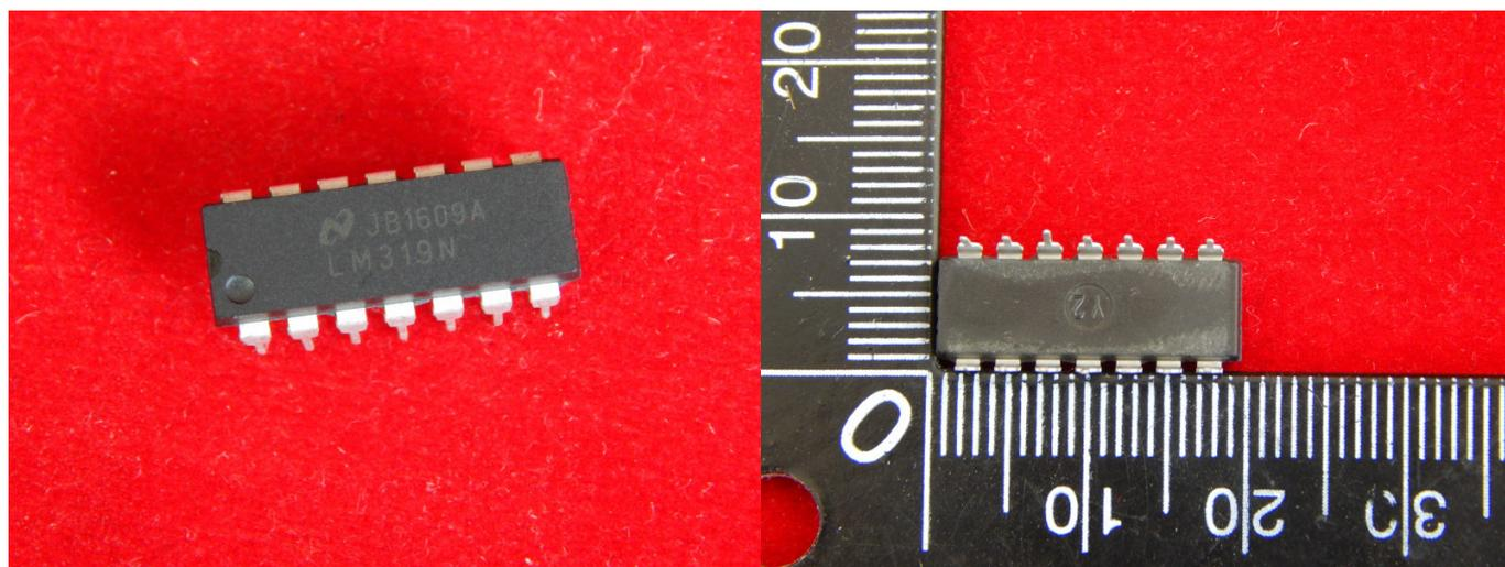
LM319N, Аналоговый компаратор, двойной, Высокоскоростной, 2, 80 нс, 5В до 36В, DIP, 14 вывод(-ов)
