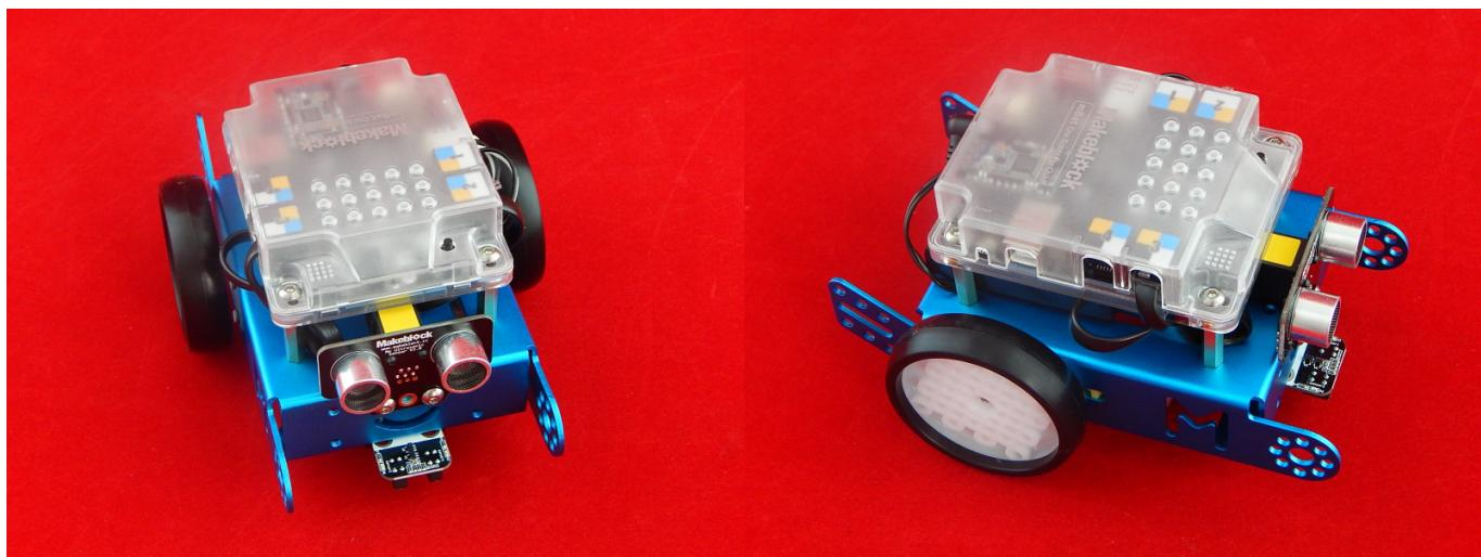
**mBot** - это обучающий конструктор, созданный одновременно для развлечения и обучения программированию, электронике и робототехнике. Работая с программой **mBlock**, создавать программы для вашего робота очень легко, так как написание программы производится методом *графического программирования* - перетаскивания мышкой и упорядочивания графических блоков-команд.
