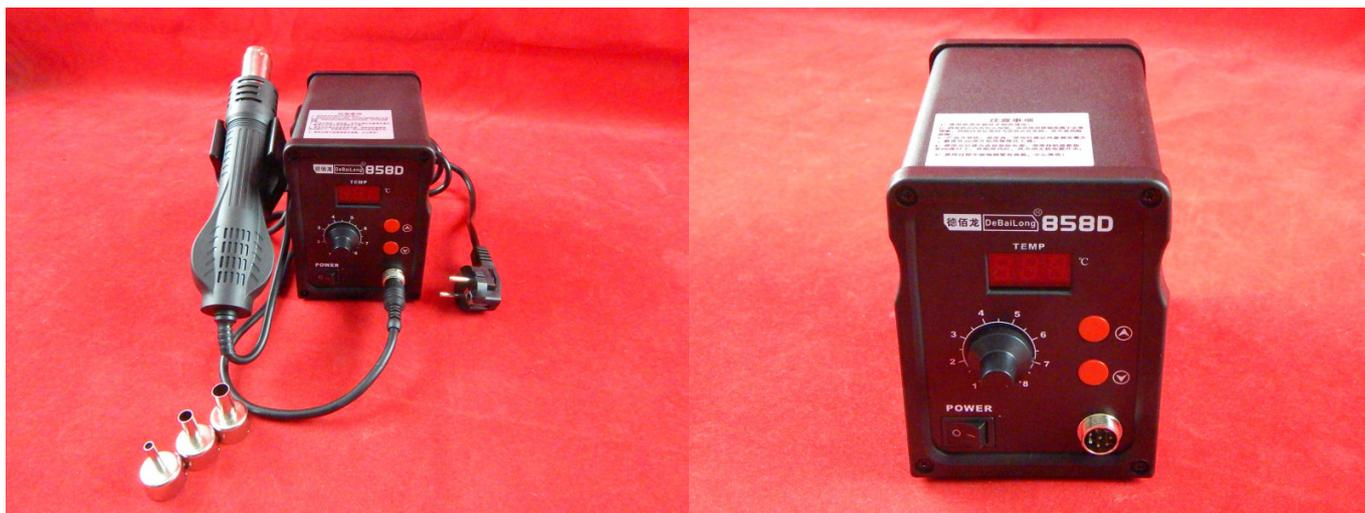
Паяльный фен оборудован цифровым индикатором для отображения данных и контроля температуры.
