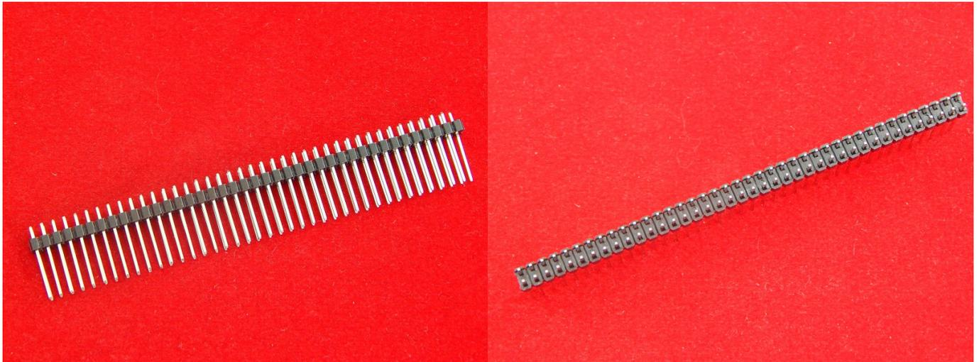
Пластина с контактами для пайки на монтажную плату.
