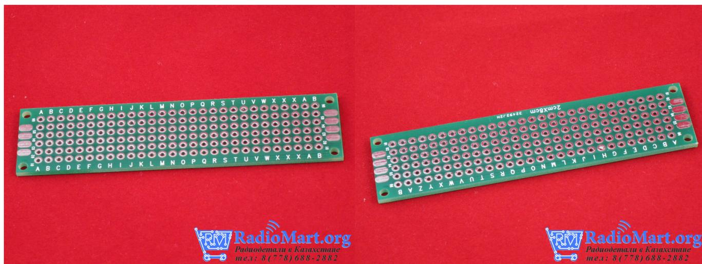
Плата для монтажа продольных конструкций.
