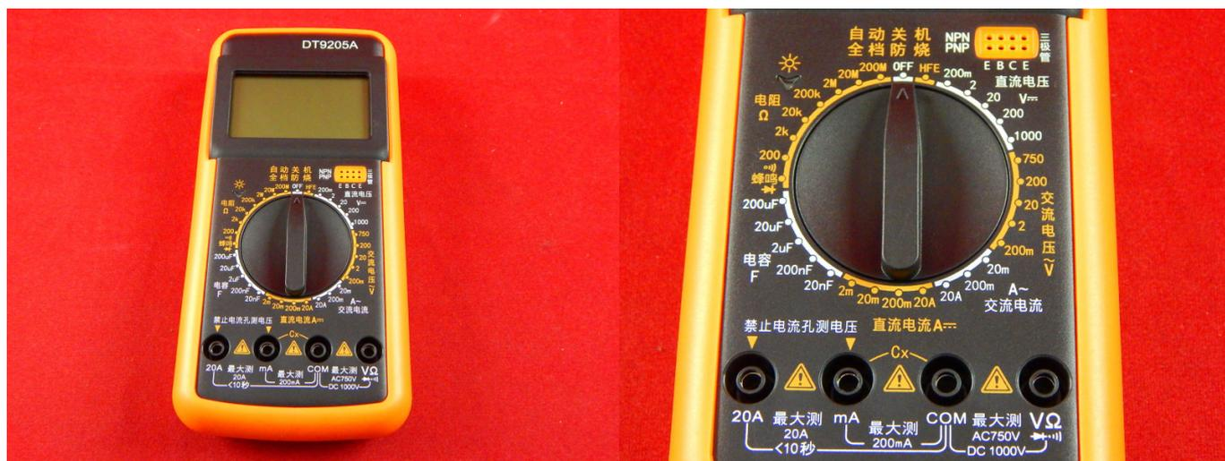
Расширенными возможностями, кроме основных величин способен измерять емкость, оборудован защитными предохранителями, большим поворотным экраном – это все про популярный мультиметр DT-9205A. Также предусмотрено автоматическое отключение питания. Отдельный разъем для проверки транзисторов. Мультиметр универсальный DT-9205A - это хороший старт для начинающего радиоэлектронщика.
