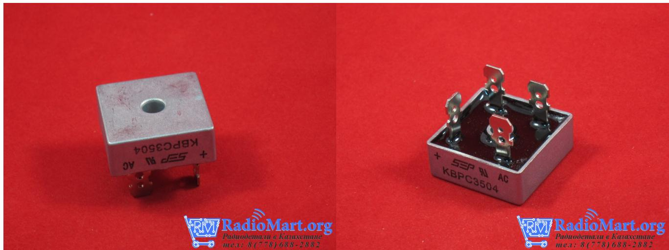
Диодный мост — предназначен для преобразования («выпрямления») переменного тока в пульсирующий.
