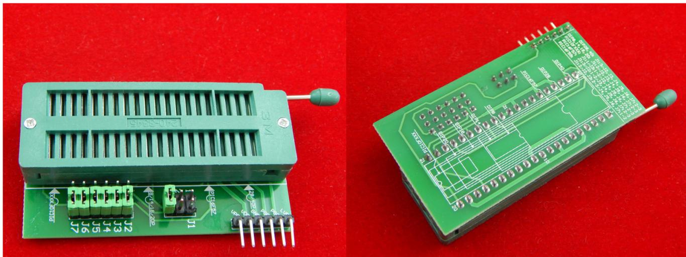
Зажим для микросхем для программаторов PICkit 2 и PICkit 3 и PICkit 3.5
