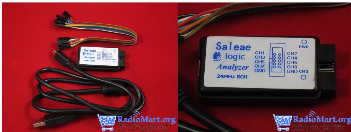
Логический анализатор (англ. Logic Analyzer) - представляет собой электронный прибор, который может записывать и отображать последовательности цифровых сигналов. Он используется для тестирования и отладки цифровых электронных схем, например, при проектировании компонентов компьютеров и управляющих электронных устройств.
