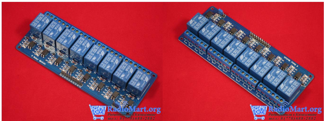
Данный модуль может управляться большим количеством микроконтроллеров, таких как Arduino, AVR, PIC, ARM и так далее.
