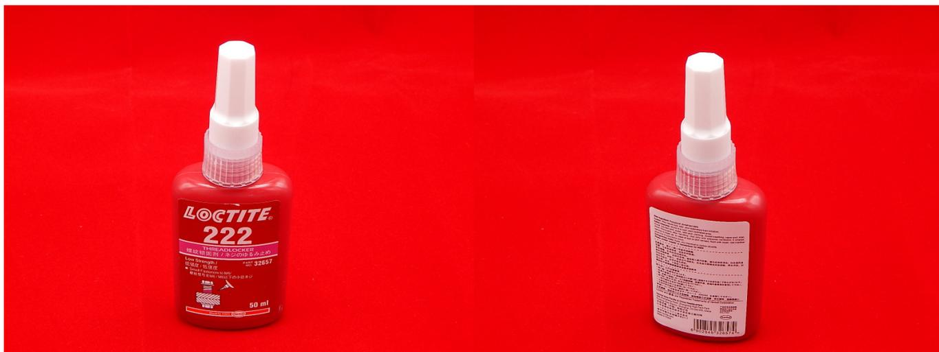
Продукт Loctite 222 является однокомпонентным анаэробным тиксотропным резьбовым фиксатором низкой прочности для легкого демонтажа соединений. Продукт полимеризуется в условиях отсутствия воздуха в небольших зазорах между металлическими поверхностями.
