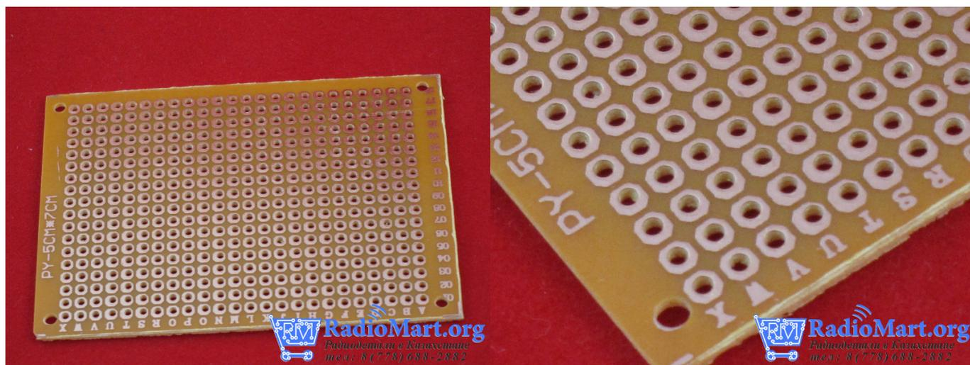
Плата для монтажа небольших схем и конструкций.
