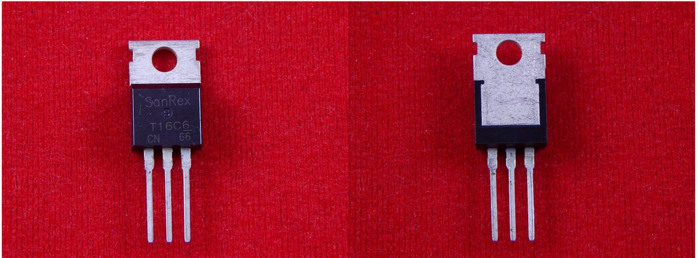
Симистор (симметричный триодный тиристор) или триак (от англ. TRIAC — triode for alternating current) — полупроводниковый прибор, являющийся разновидностью тиристоров и используемый для коммутации в цепях переменного тока. В электронике часто рассматривается как управляемый выключатель (ключ).
