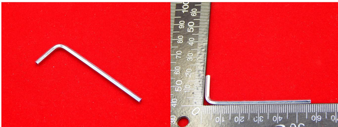
Шестигранный ключ – это ручной инструмент, который предназначен для работы с крепежными элементами, имеющими шестигранный шлиц. С его помощью можно откручивать и закручивать винты с цилиндрической головкой и шестигранным углублением.
