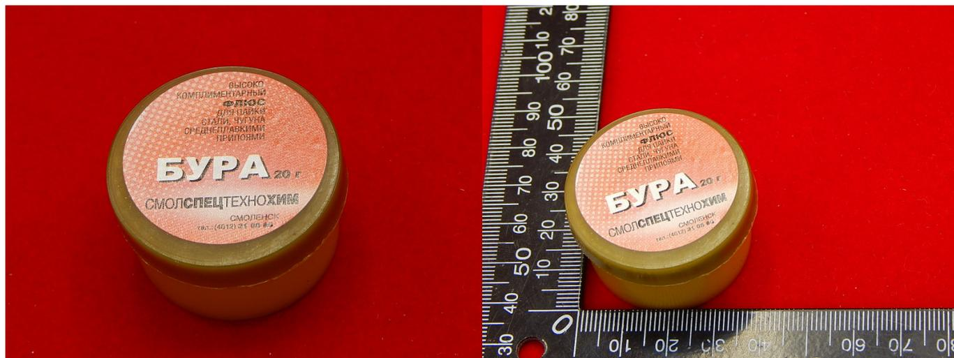
Высокотемпературный флюс бура применяют для пайки углеродистых сталей, чугуна, меди, твердых сплавов среднеплавкими медными и серебряными припоями. При нагревании превращается в стекловидную массу. Соли, образующиеся при пайке бурой, необходимо удалять механической зачисткой.
