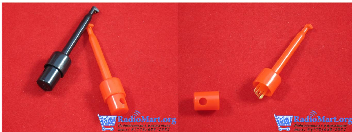
Тестовые щупы для подключения к ножкам радиодеталей и проводам с зажимом.
