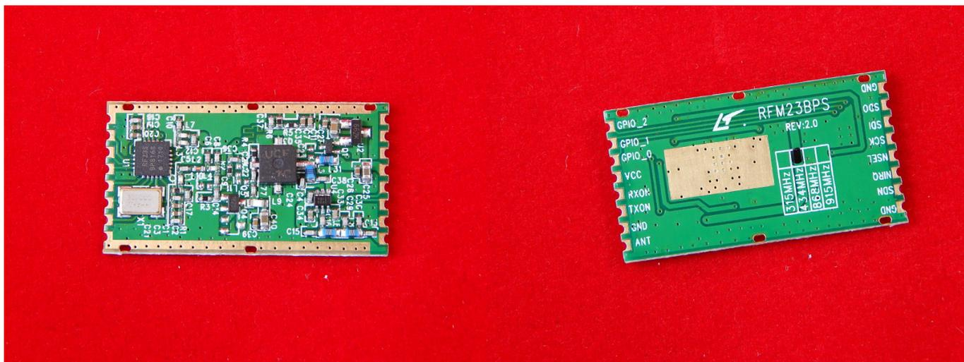
RFM23BP-433-S2 ISM модуль передачи данных. Модуль: RF; трансивер FM; FSK; 433,92МГц; SPI; -120дБм; 3,3÷6ВD
