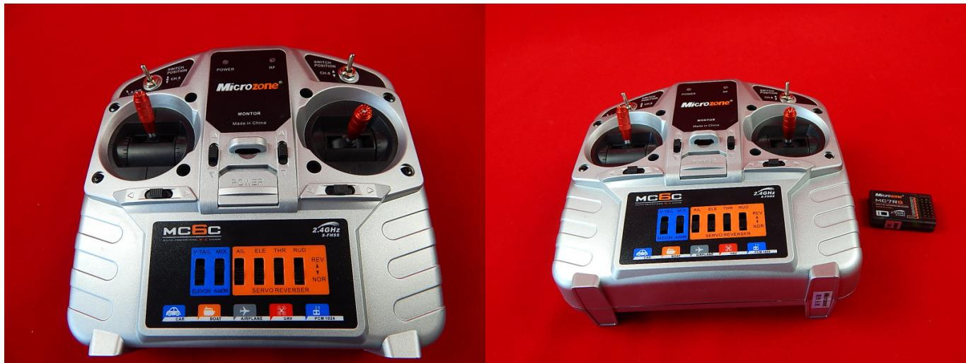
6-ти канальная аппаратура Microzone MC6b 2.4GHz Отлично подойдет для авиа-, судо- и автомоделей. Данная аппаратура относится к MODE-2 типу.
