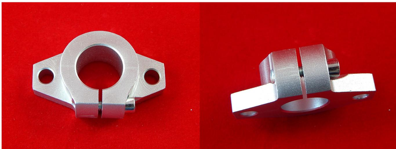
Держатель направляющего полированного вала диаметром 20 мм, серия SHF. Для фиксации вала перпендикулярно опорной плоскости.
